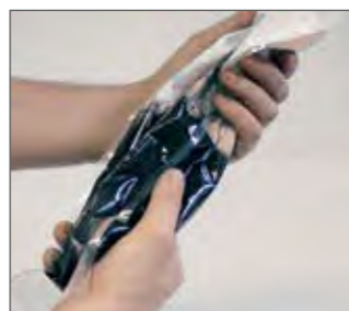
2.- Mezclar componentes Retirar barrera entre los componentes y mezclar convenientemente hasta lograr un color homogéneo de la misma.
