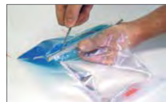
1.- Retirar la barrera entre los dos componentes
