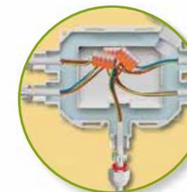
Conexión con conectores de palanca planos
